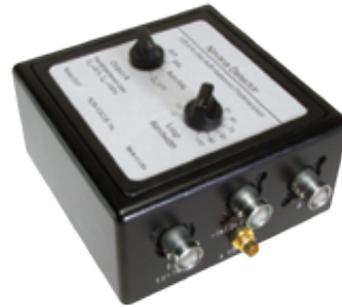
Newport Nirvana 系列平衡光电探测器非常适合需要灵敏测量和更高信噪比的光学检测应用，例如外差检测。我们的专利电路有效地消除了极低功率测量的背景噪声，从而在 400-1070 或 800-1700 nm 波长范围内降低 50 dB 的噪声快速测量信号功率。同时还提供自由空间或光纤耦合光输入选项。
