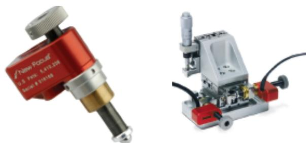
Picomotor 系列压电线性促动器利用专利技术在自动移动定位器和支架时提供小于 30 nm 的极小步距。它们非常适合旨在观察极小变化和特征的量子技术研究。Picomotor 执行器在不通电时不会移动，从而确保了长期的定位稳定性。它们的标准尺寸安装选项使它们可以轻松集成到标准千分尺安装孔中。
