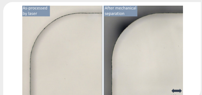
그림 2. 고 굴절률 유리의 0.5-mm 반경 둥근 모서리 가공 현미경 이미지. (왼쪽) 수동 분리하기 전 윗면 이미지와 분리 후 윗면 이미지(오른쪽).
