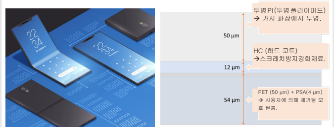
그림 1. 왼쪽-유연디스플레이는모바일기기기술의혁신적인발전인폴더블폰을 가능하게 한다. 오른쪽-이 어플리케이션 노트에서 연구 한 재료의 층 구조 도식.
